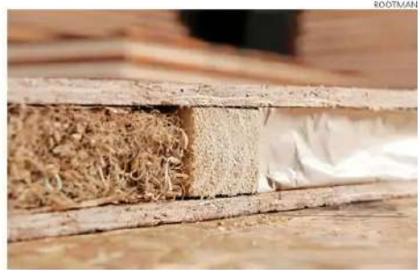
El material de raíces tiene aislación térmica y acústica, resistencia al fuego y permeabilidad al vapor.
