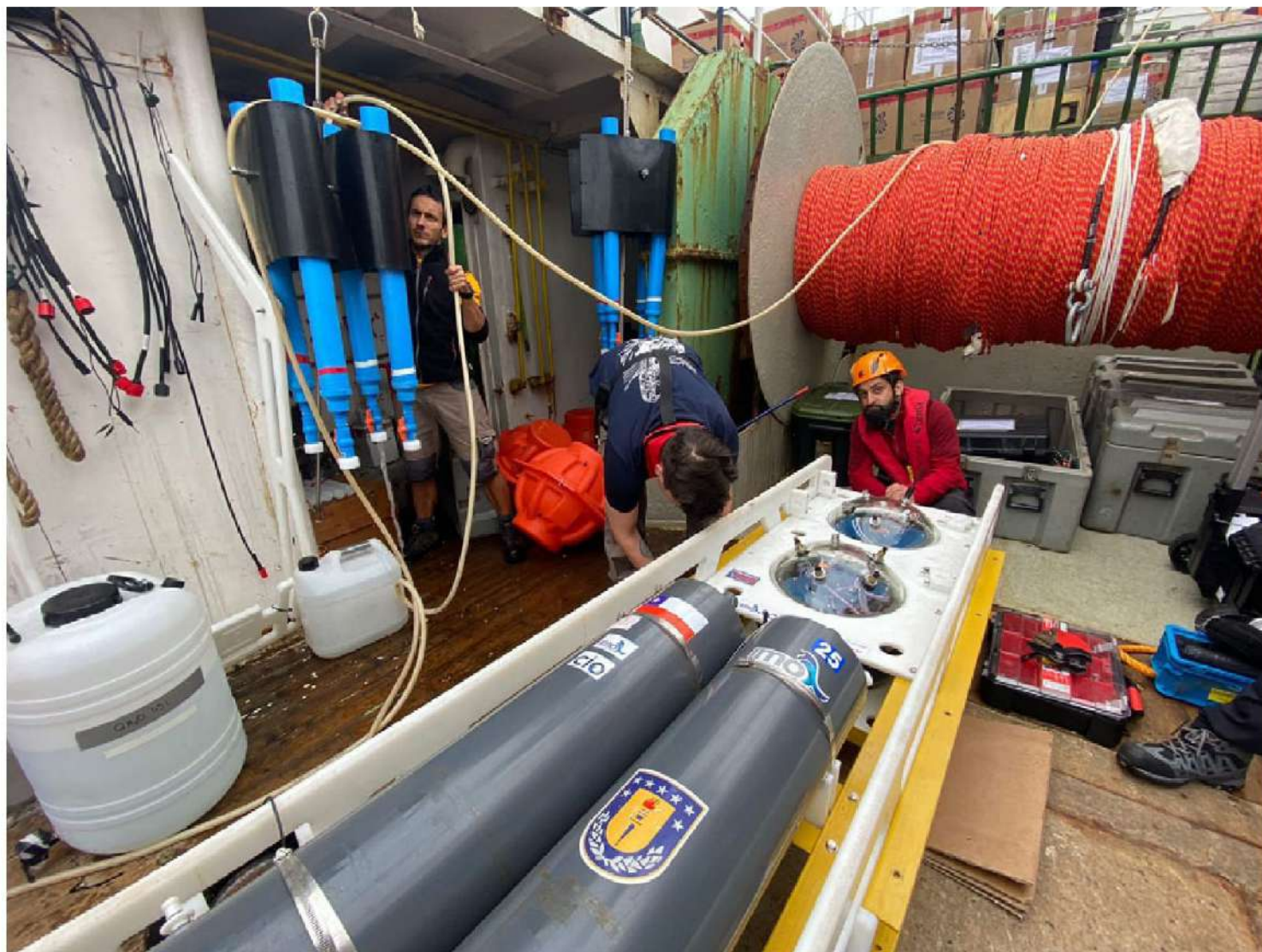
► Los ingenieros y técnicos del IMO, junto con el Centro de Instrumentación Oceanográfica (CIO), diseñaron un nuevo lander, que es un vehículo autónomo no tripulado.
